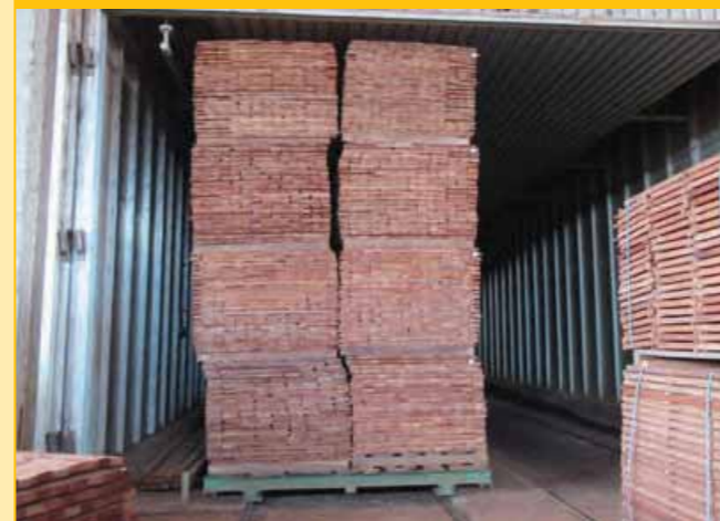
加工好的木材在巨大的木材干燥窑内部和外部进行干燥。
